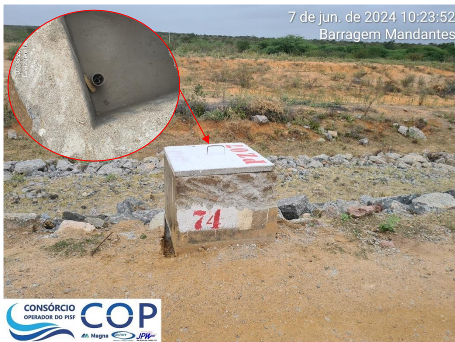
Foto 6.15: Piezômetro – PZ-07 na estaca E-74.
